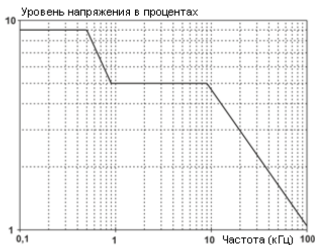
Рис.49. Допустимые уровни управляющих сигналов.
