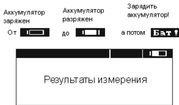
Контроль состояния зарядки аккумуляторов
