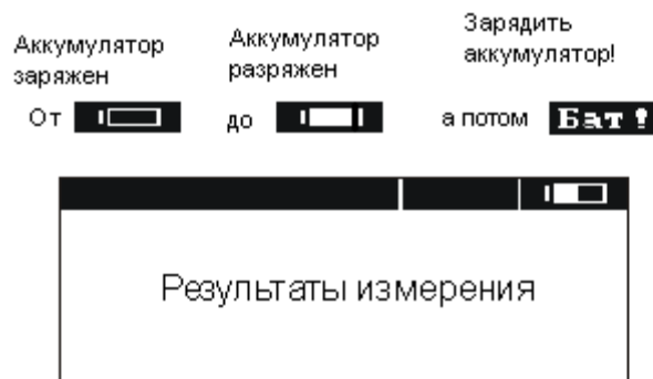
Контроль состояния зарядки аккумуляторов
