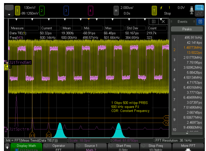
Рисунок 19. Анализ периодического джиттера (прямоугольного) в сигнале псевдослучайной двоичной последовательности 1 Гбит/с.
