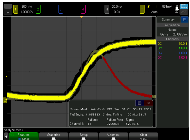
Рисунок 40. Тестирование на отклонения для выявления редких выбросов.
