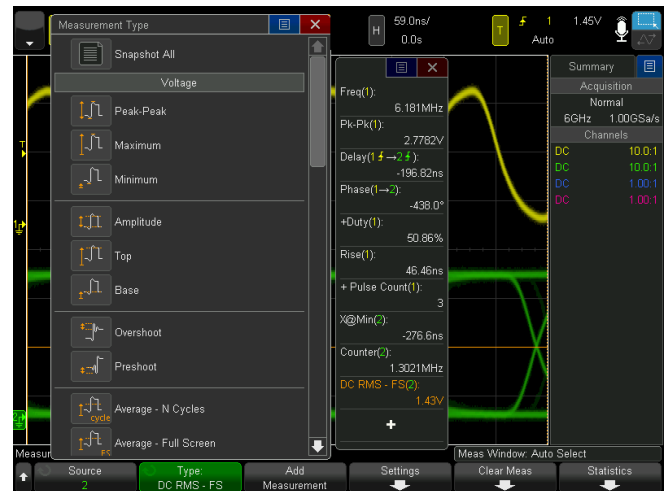
Рисунок 50. Меню выбора вида измерения. Для выбора следует провести пальцем и дважды коснуться функции.
