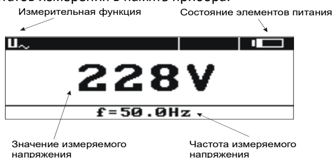
Вид экрана во время измерения переменного напряжения
