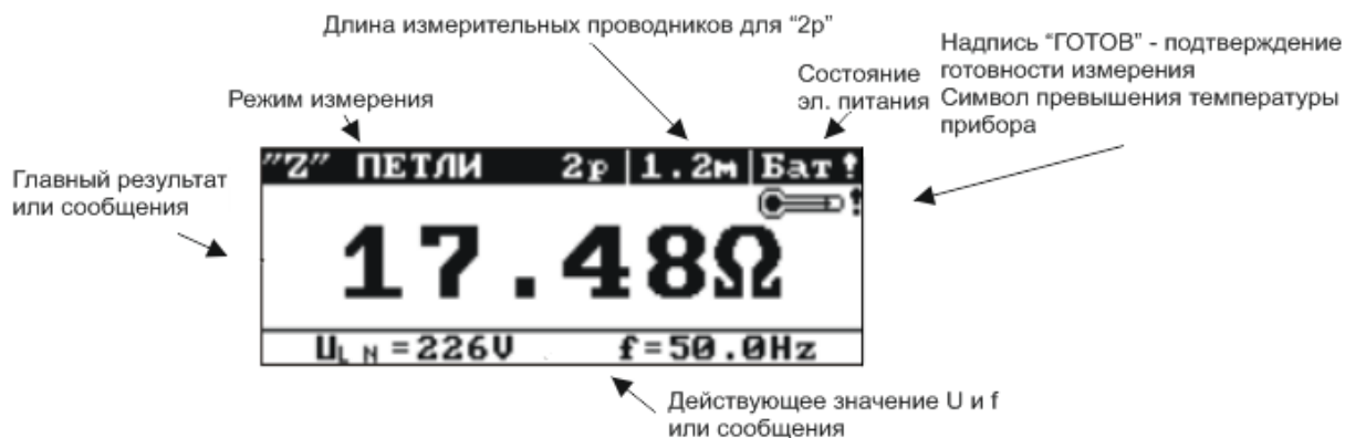
Вид экрана в режиме измерения полного сопротивления петли короткого замыкания (только главный результат)
